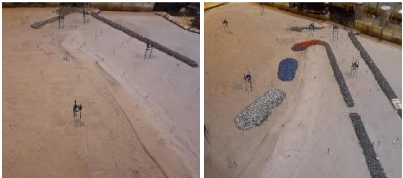
Figura 159 – Forma da restinga no fim da 1ª série de testes sem estruturas (esquerda) e com estruturas (direita).
