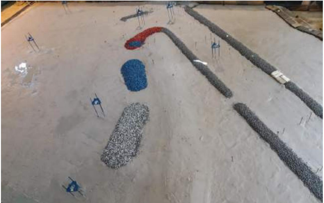
Figura 168 – Modelo físico construído para o cenário 2 que contempla um dique interno de guiamento e quebramares destacados externos de coroamento a cota baixa. Solução preliminar ainda não otimizada.
