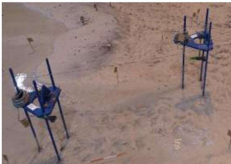
Figura 133 – Bandeiras instaladas no modelo e sondas hidrodinâmicas.
