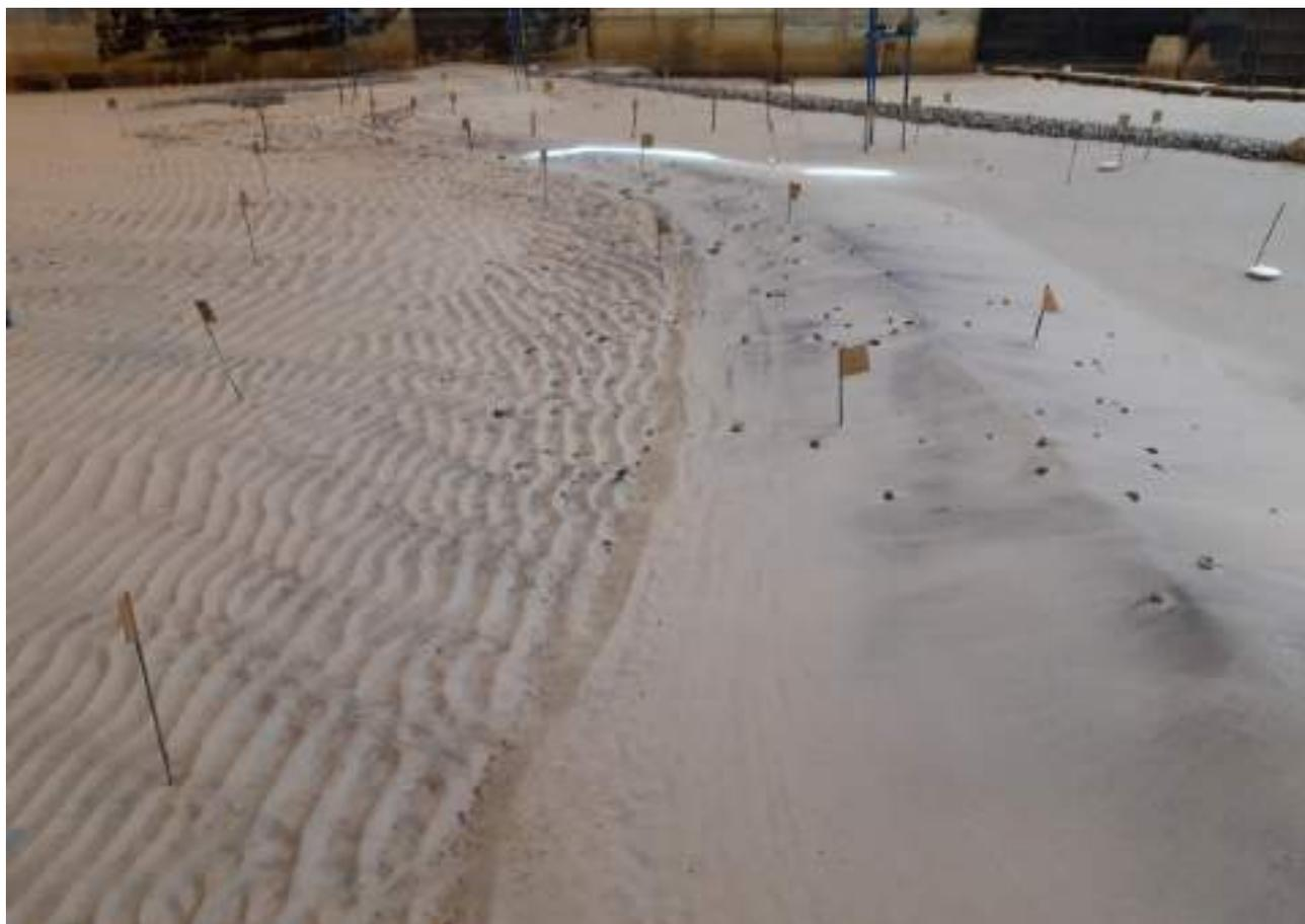
**Figura 167 – Configuração da restinga de Ofir no final das séries de testes realizadas para o Cenário 1 (sem intervenção de proteção).**
