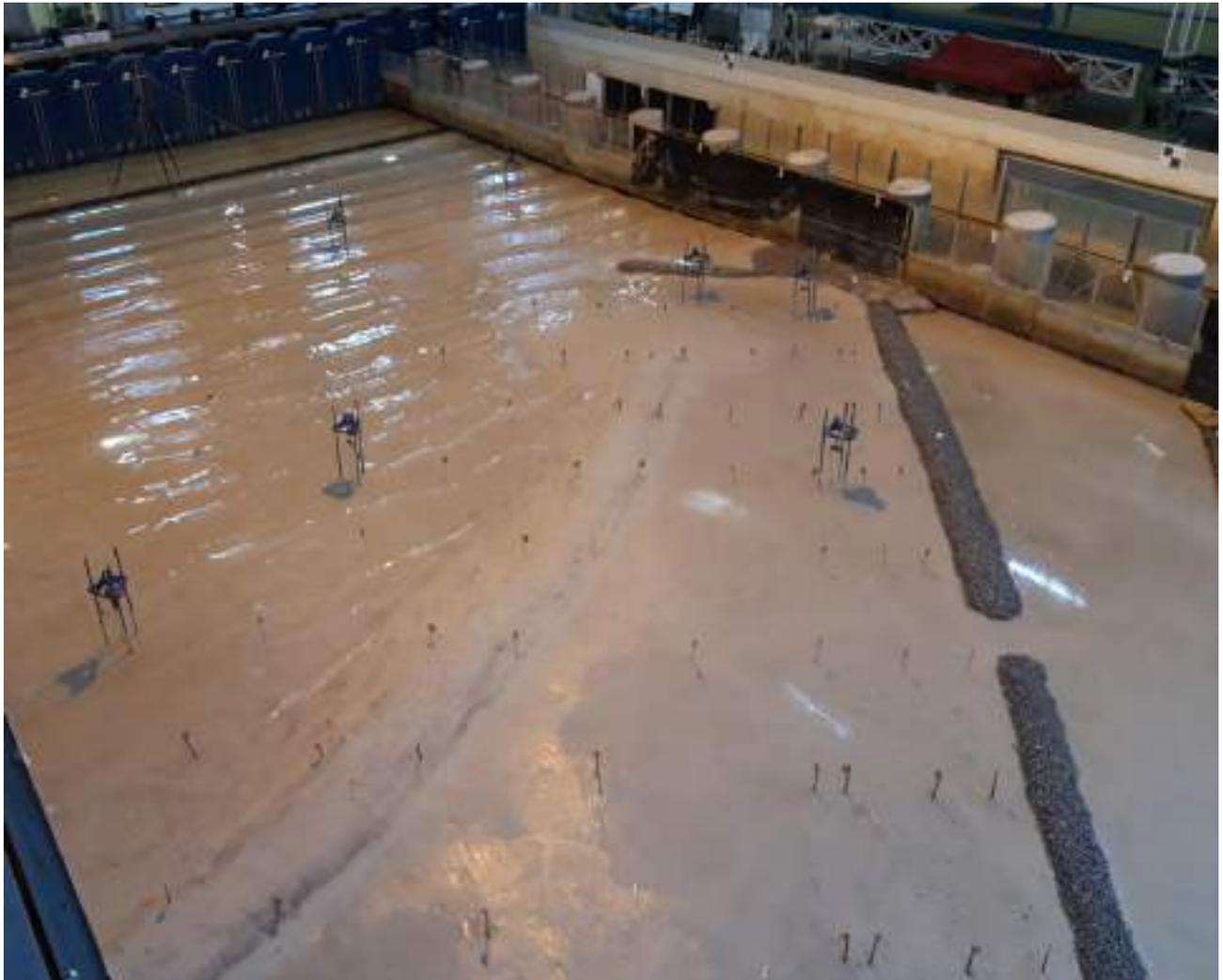
**Figura 165 – Início dos testes experimentais: cenário 1, sem intervenção de proteção.**
