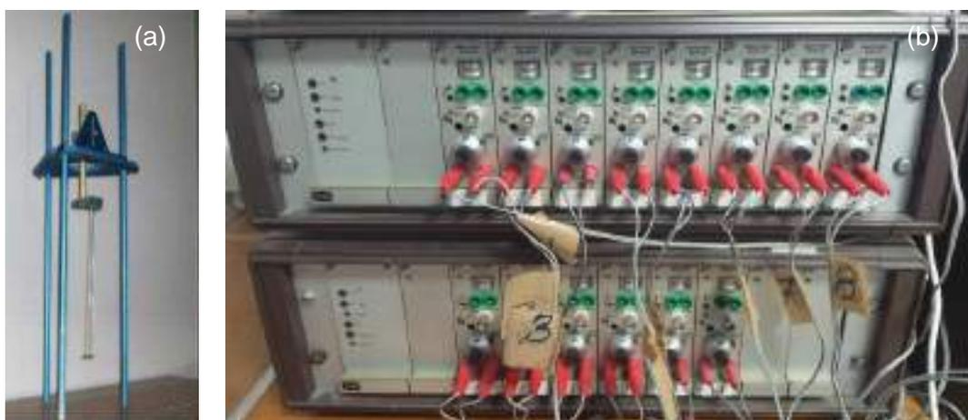
Figura 129 – Sonda hidrodinâmica colocada no seu suporte (a), os dois módulos de aquisição (b).
