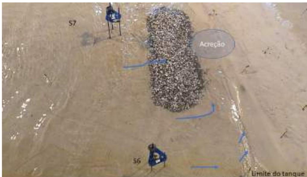
Figura 158 – Fronteira com a parede sul do tanque de ondas e sentido aparente de escoamento (teste 2, com estruturas).
