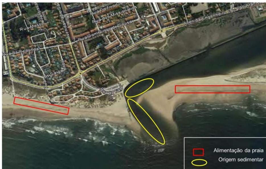
**Figura 26 - Origem dos sedimentos dragados na embocadura do rio Cávado e alimentação artificial da praia de Suave Mar e da restinga de Ofir, adaptado de [3].**
