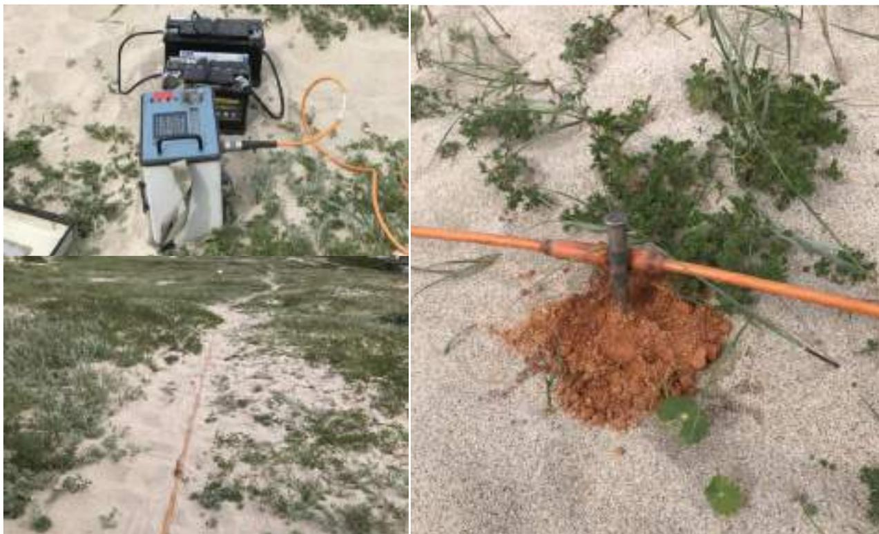
Figura 77 – Resistivímetro, modelo SYSCAL R1 Plus - IRIS Instruments (canto superior esquerdo); Cabo de perfil geofísico com eléctrodos (canto inferior esquerdo); Eléctrodo com isolamento por argila (direita).
