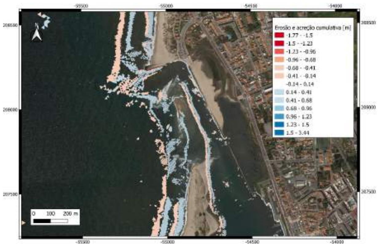
Figura 112 - Mapa de erosões e acreções cumulativas após o teste 02 sem as novas estruturas.
