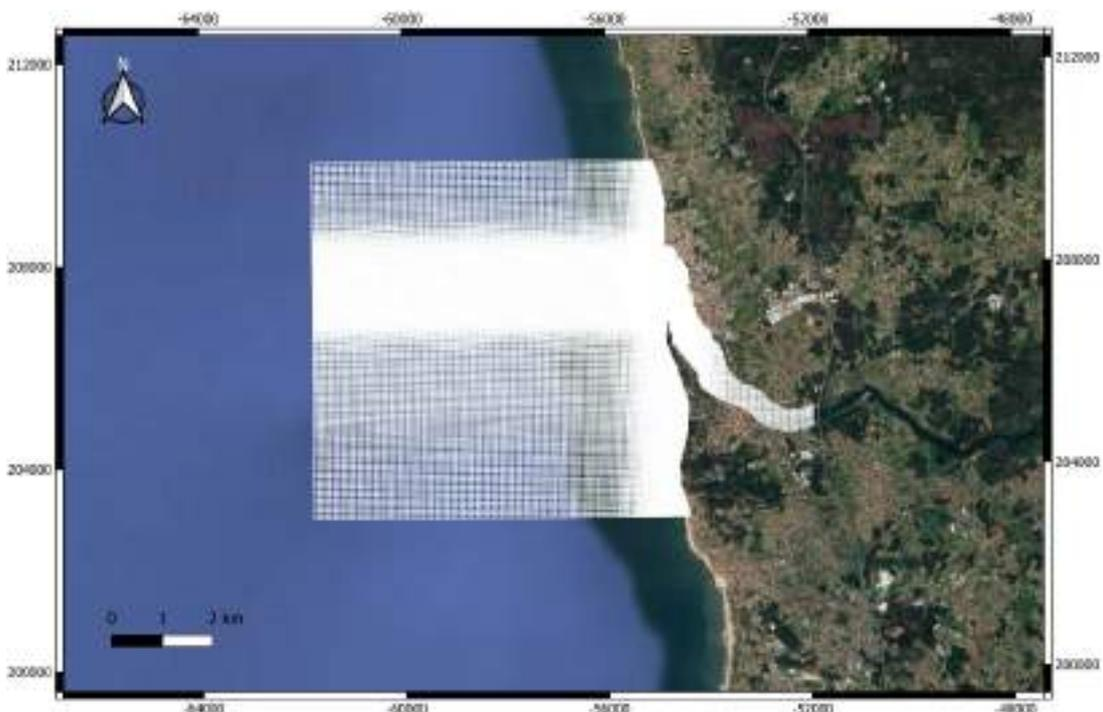
Figura 97 - Malha global estruturada utilizada no módulo WAVE (Sistema de coordenadas: ETRS89 / Portugal TM06).
