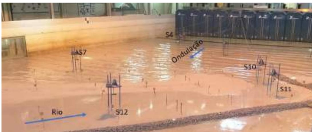
Figura 149 – Localização das sondas no modelo físico.
