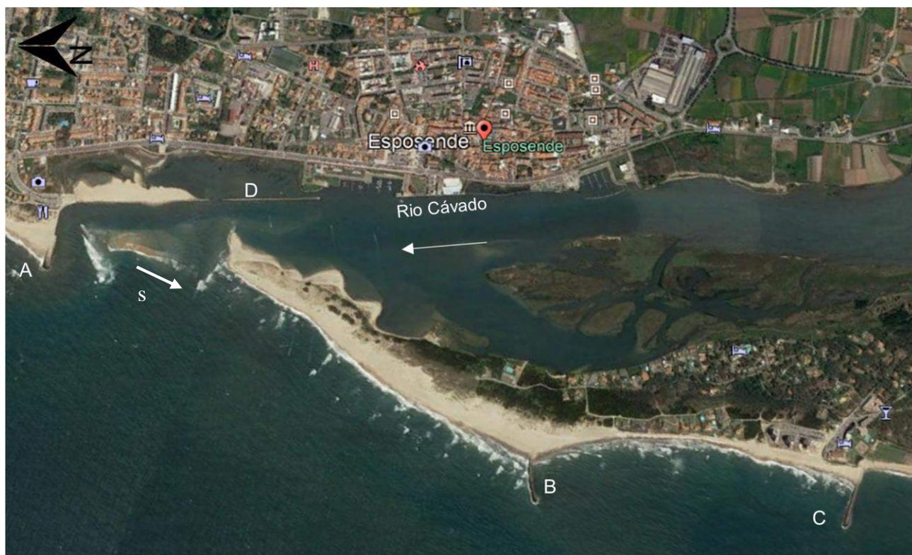
**Figura 10 - Caracterização do estado atual da embocadura do rio Cávado e obras existentes: A) molhe norte; B) esporão da restinga; C) esporão da praia de Ofir; D) dique; s) sentido da deriva litoral (Google Earth, 2019).**
