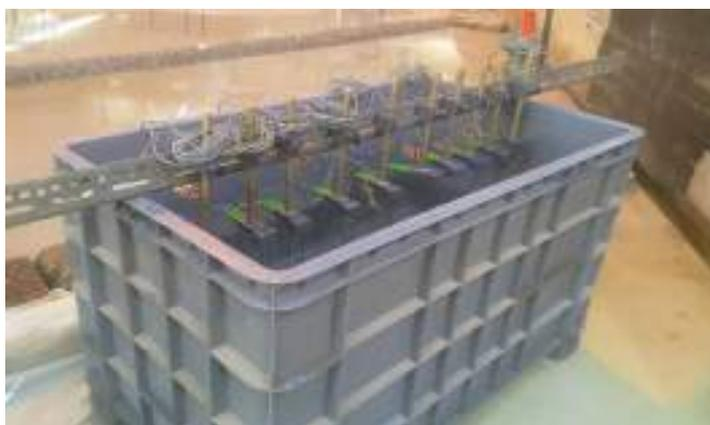
Figura 130 – Reservatório para calibração das sondas hidrodinâmicas.
