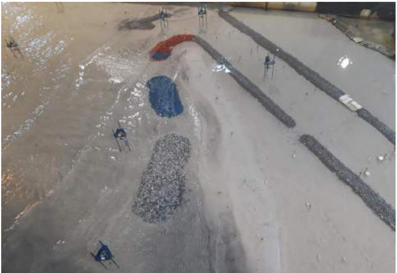
Figura 169 – Modelo físico durante os testes experimentais da fase 2 (com intervenção de proteção).
