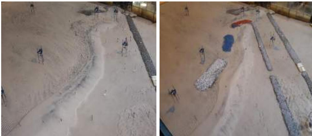
**Figura 164 – Forma da restinga no final das séries de testes sem estruturas (esquerda) e com as novas estruturas de proteção (direita).**
