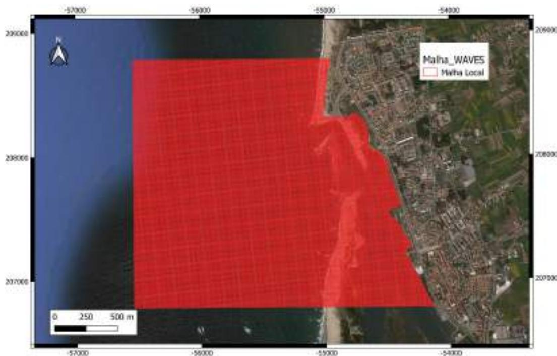
**Figura 98 - Malha local estruturada utilizada no módulo WAVE (Sistema de coordenadas: ETRS89 / Portugal TM06).**
