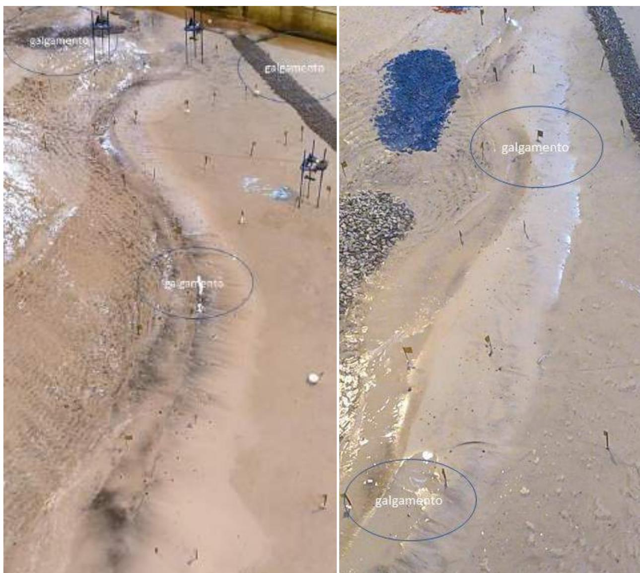
Figura 161 – Galgamentos observáveis na fase de testes sem estruturas (esquerda) e com estruturas (direita) do teste 16 (Nível de Água Extremo + 0.5;  $H_s = 7$  m;  $T_p = 18$  s; Caudal fluvial =  $630$  m<sup>3</sup>/s).
