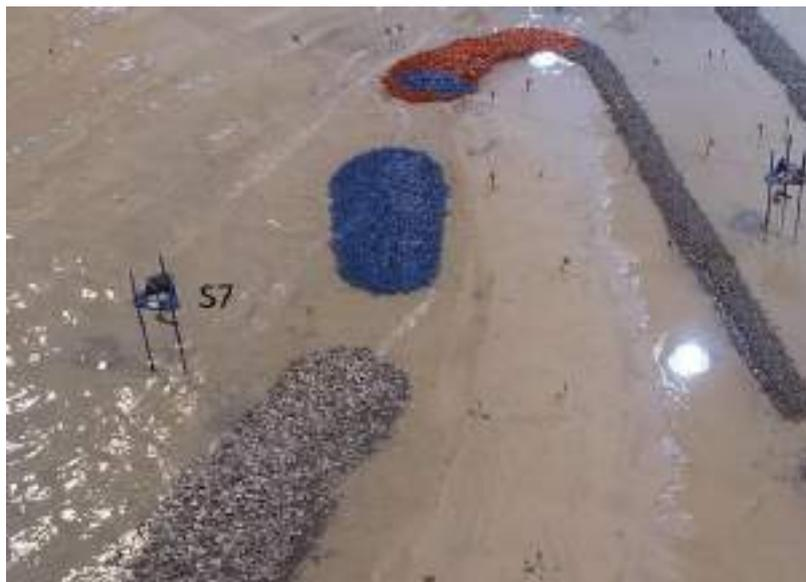
**Figura 153 – Posição da sonda S7 relativamente ao quebramar destacado.**
