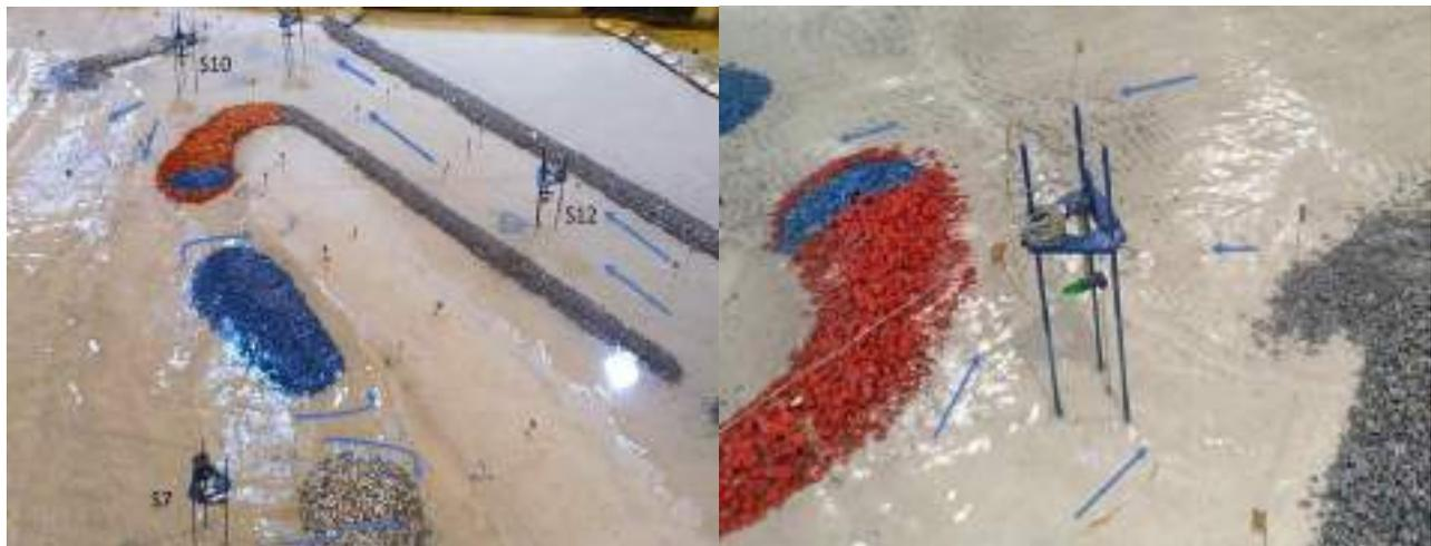
Figura 156 – Sentido e direção do escoamento: (esquerda) escoamento geral; (direita) pormenor do escoamento na embocadura (teste 2, com estruturas).
