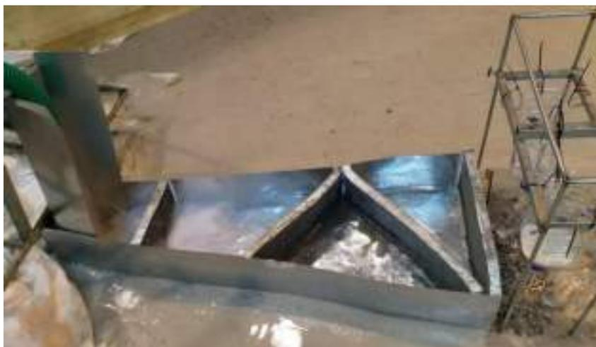
**Figura 132 – Estabilizador de escoamento (esquerda) e descarregador de caudal sólido (direita).**
