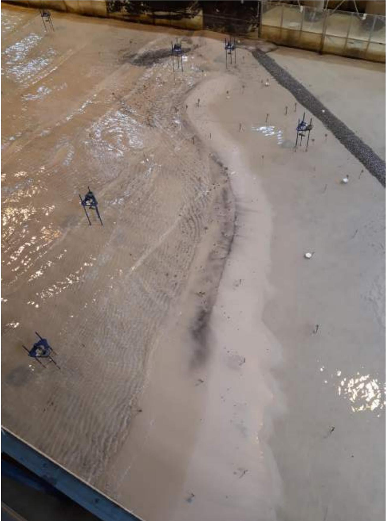
Figura 166 – Modelo físico na fase final das séries de testes realizadas para o Cenário 1 (sem intervenção de proteção).
