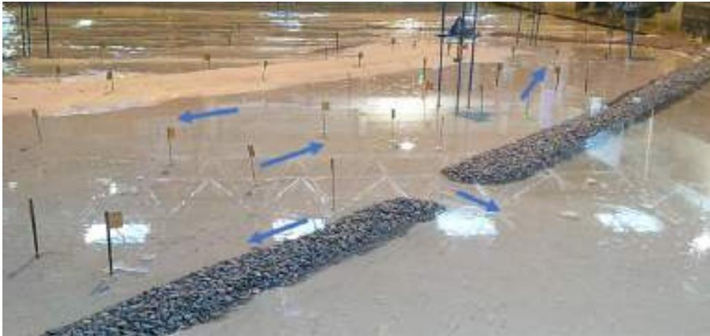
Figura 155 – Sentido e direção do escoamento superficial no interior do estuário (teste 2, sem estruturas).
