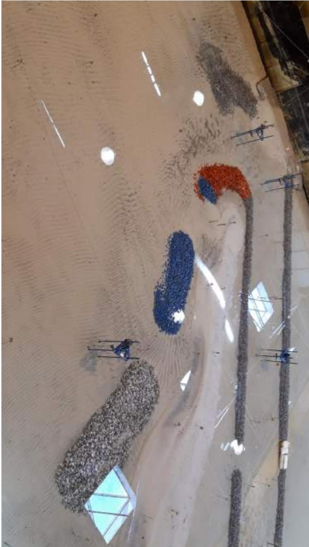
Figura 170 – Modelo físico durante os testes experimentais da fase 2, evidenciando a configuração da restinga na zona protegida pelos quebramares destacados.
