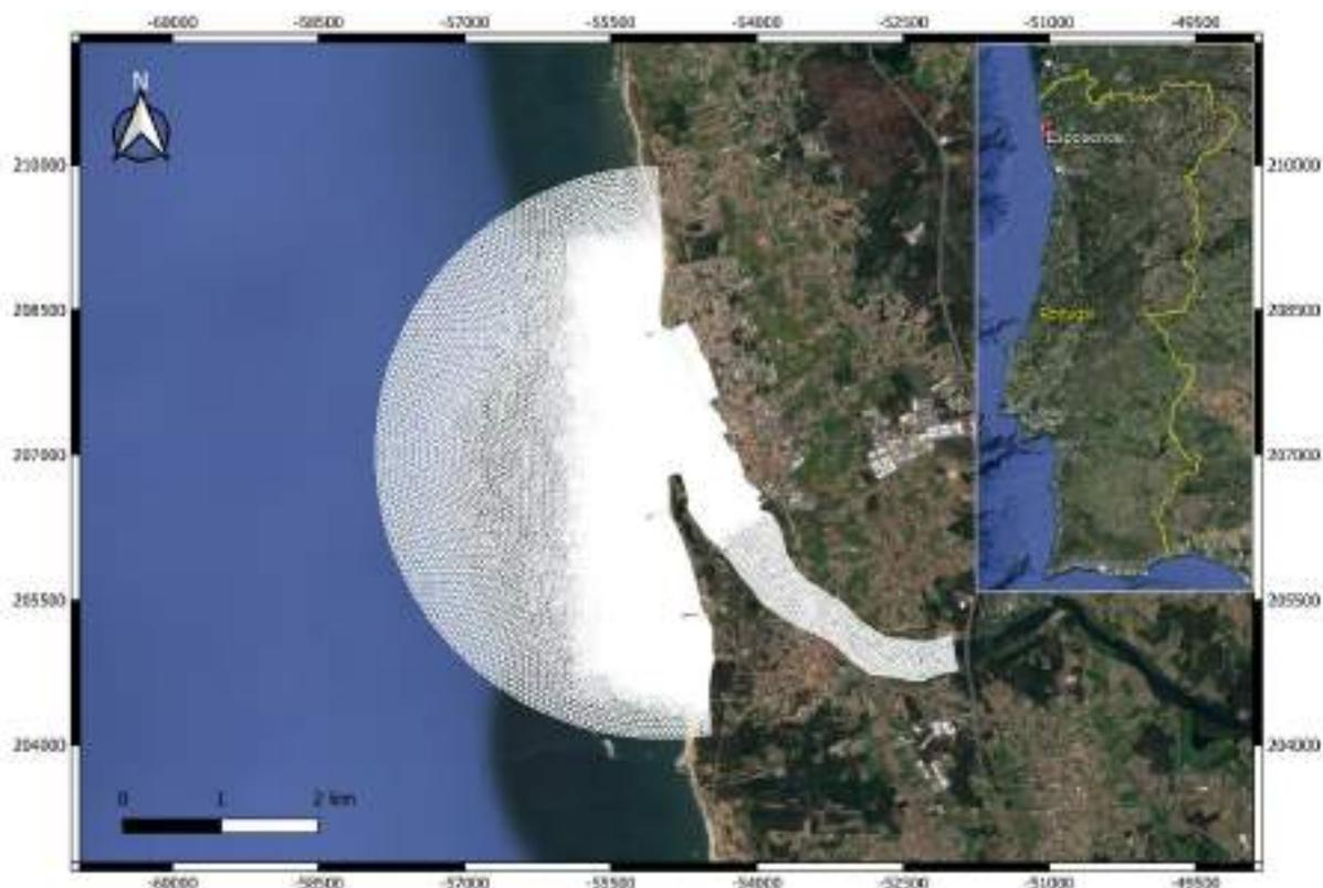
Figura 95 - Malha não estruturada usada no módulo FLOW (Sistema de coordenadas: ETRS89 / Portugal TM06).
