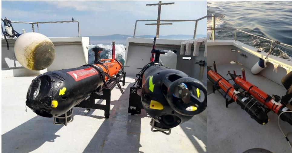
Figura 2-9: Os 4 AUVs usados nos levantamentos equipados com sonar de varrimento lateral.
