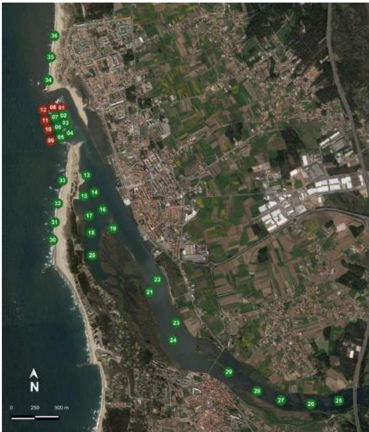
Figura 69 – Plano de amostragem de sedimentos do Rio Cávado e na praia situada na vizinhança da sua foz (nos pontos a vermelho não ocorreu qualquer colheita por questões de segurança).
