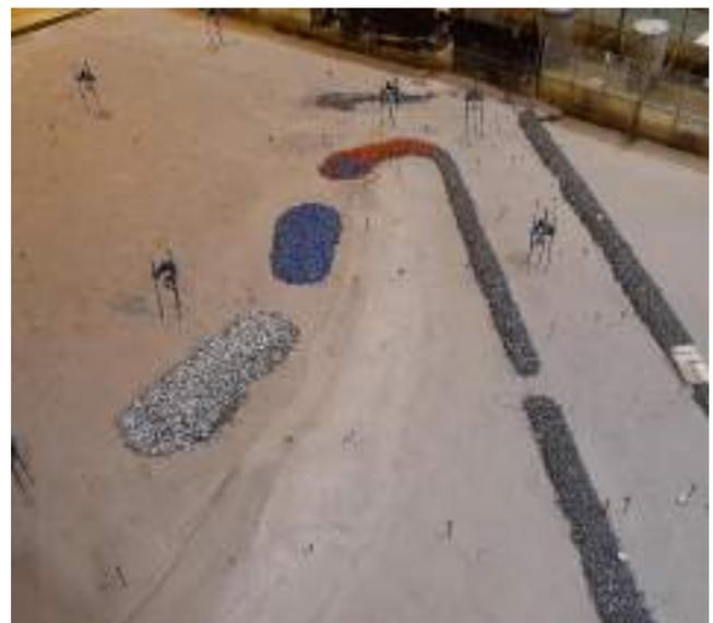
Figura 159 – Forma da restinga no fim da 1ª série de testes sem estruturas (esquerda) e com estruturas (direita).
