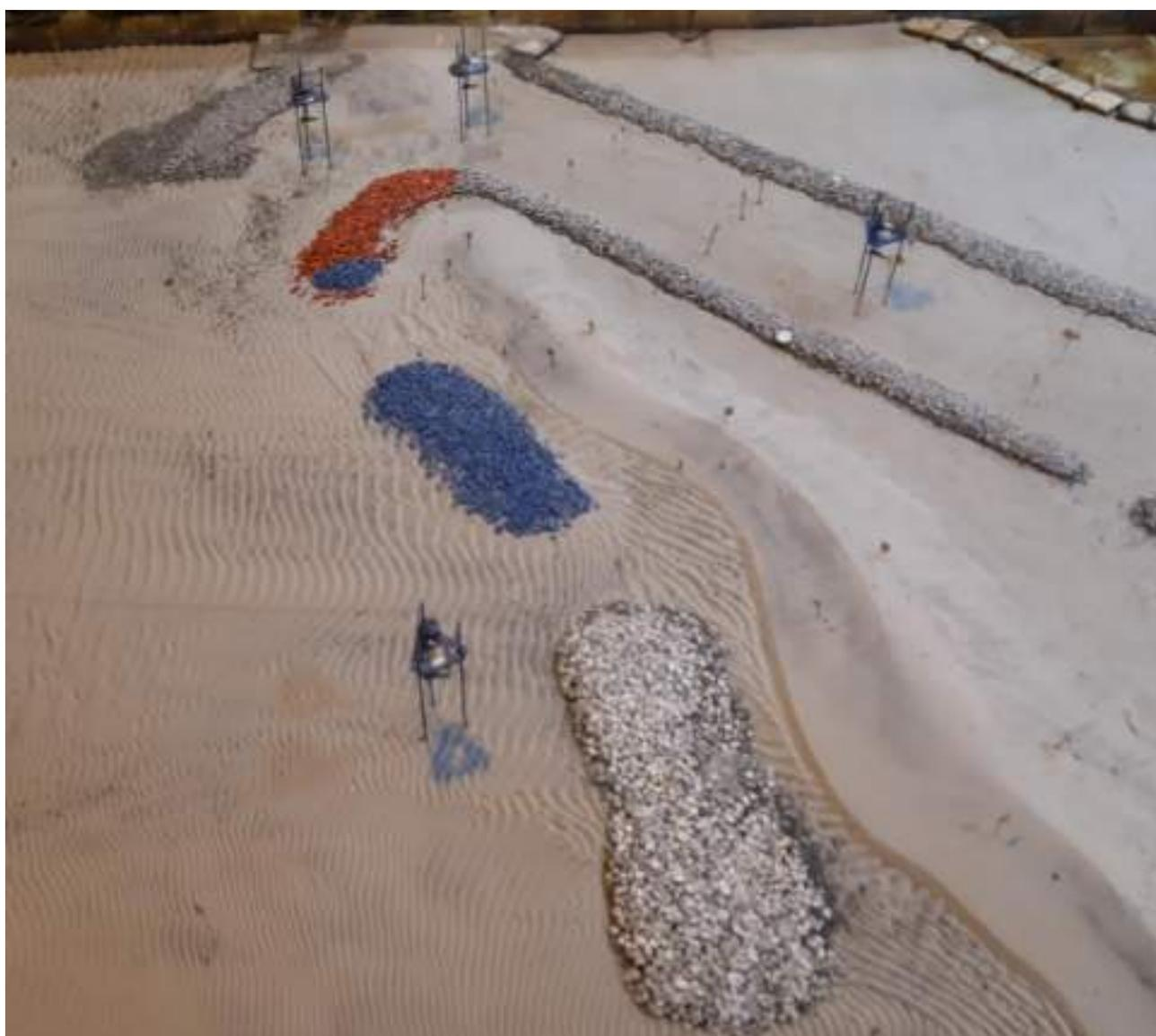
Figura 171 – Configuração da restinga de Ofir no final das séries de testes realizadas para o cenário 2 (com as intervenções de proteção).
