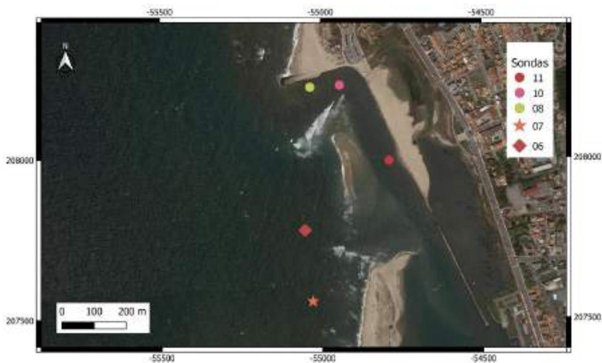
Figura 104 - Localização das sondas para monitorização dos níveis de água.
