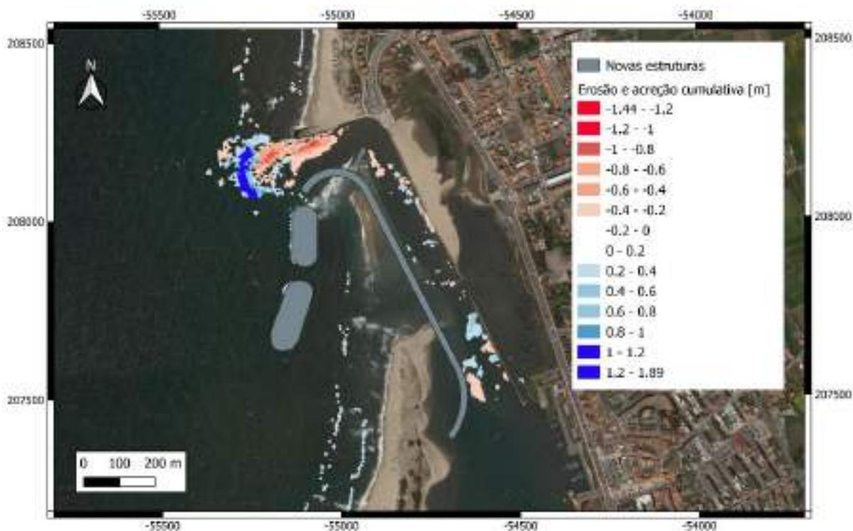
Figura 119 - Mapa de erosões e acreções cumulativas após o teste 01 com as novas estruturas.
