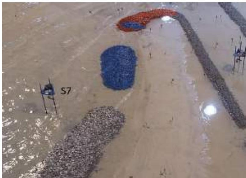
**Figura 153 – Posição da sonda S7 relativamente ao quebramar destacado.**
