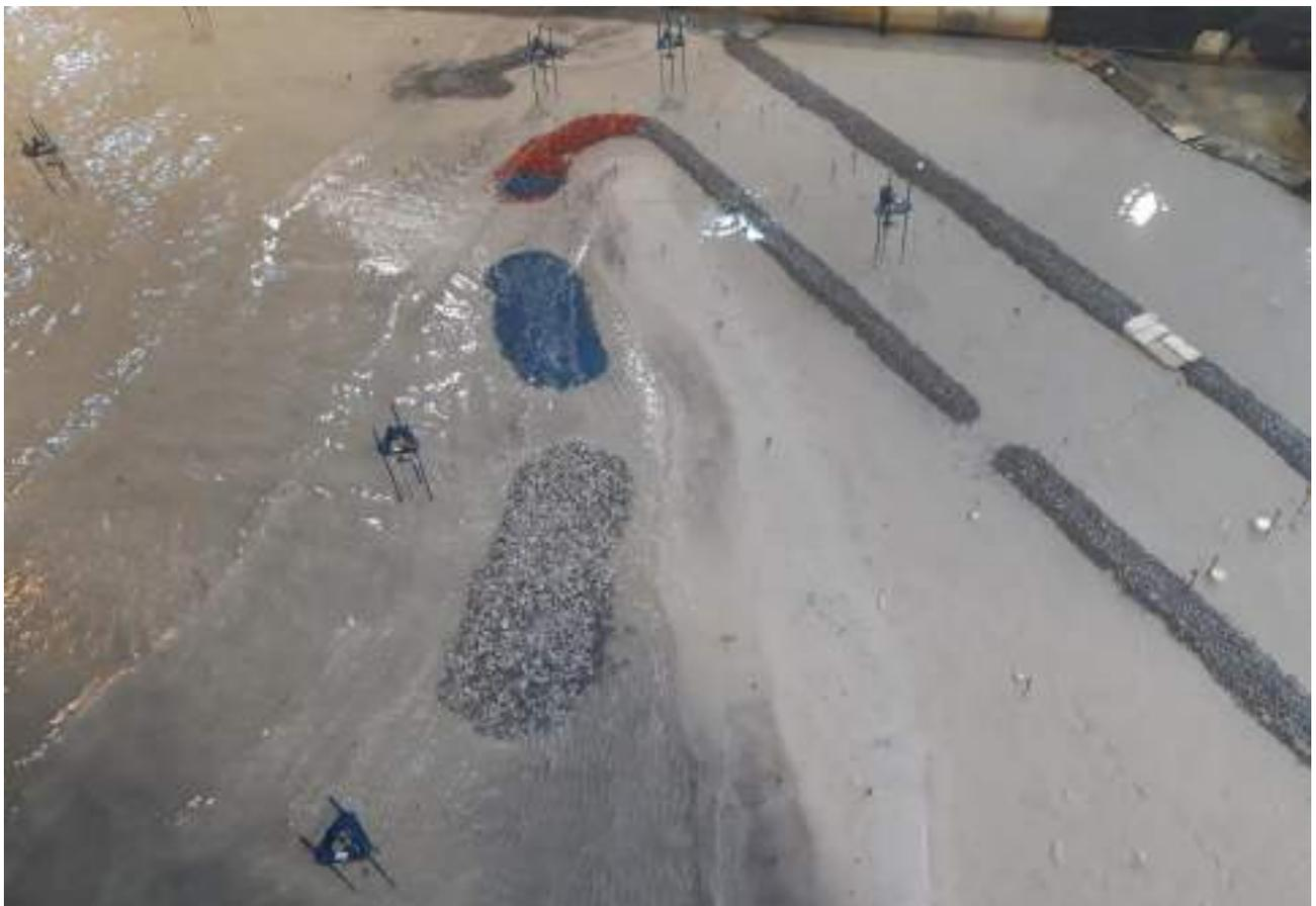
**Figura 169 – Modelo físico durante os testes experimentais da fase 2 (com intervenção de proteção).**
